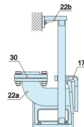
Установка с автоматической трубной муфтой (Z)
