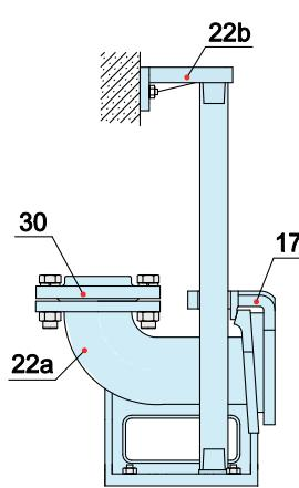
Установка с автоматической трубной муфтой (Z)
