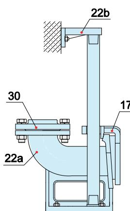
Установка с автоматической трубной муфтой (Z)
