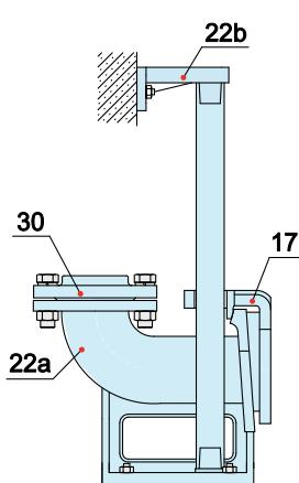
Установка с автоматической трубной муфтой (Z)
