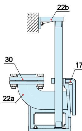
Установка с автоматической трубной муфтой (Z)
