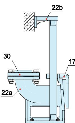
Установка с автоматической трубной муфтой (Z)
