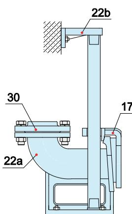
Установка с автоматической трубной муфтой (Z)
